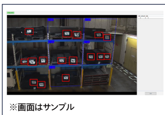
▲“練りゴム”収納棚のエフをPTZカメラが瞬時に読み取り、PCやタブレットでチェック可能
