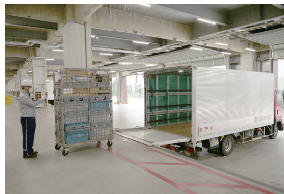
▲ドライバーはスマートフォンでパレットの二次元コードを読み取り、トラックへ積込(積載予定ではないパレットの二次元コードを読み取るとアラート通知)
