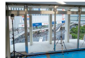
▲ プロジェクターの隣に設置された混雑状況検知用のネットワークカメラ
