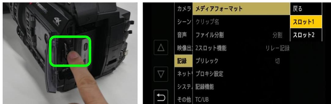
SDメモリーカードをAG-CX350本体のSDカードスロット(SLOT1または2)に挿入します。
