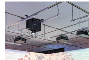
▲ 最後の空間“雅”(メインビジュアルの写真)は7台のPT-MZ20Kで壁面と立体の山に投写
