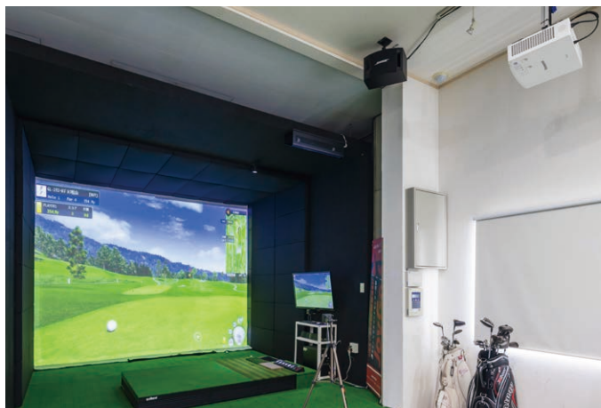
▲ プレーヤーや周辺機器の影が映り込みにくいよう、スクリーンの右側から投写されている。映像補正はキーストンなどで調整。
