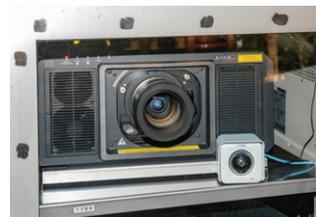
▲ プロジェクターの横に監視カメラを置き、投写映像を遠隔で確認可能
