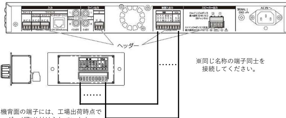
本機背面の端子には、工場出荷時点でヘッダーが取り付けられています。
