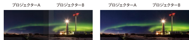
平均照度:5% オフ時 平均照度:15% オン時 全体平均照度:10% オン時 全プロジェクター映像の平均照度に基づいてダイナミックコントラストを設定し、エッジ部分もスムーズに表示。
