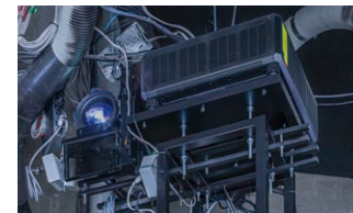
▲短焦点レンズを装着したPT-RQ18KJを船橋の屋根上に4台設置し曲面スクリーンに投写。
