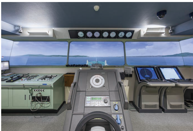
▲実際の船舶に使われている航海機器を備え、リアルタイムで船舶の動きを再現し操船訓練を行う。
