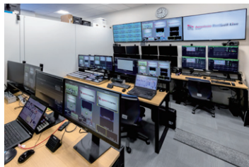
▲rtv様のサブ全景。中央列にコントロールパネルを配置し、その隣と後ろには「Kairos Creator」用のPCを配置
