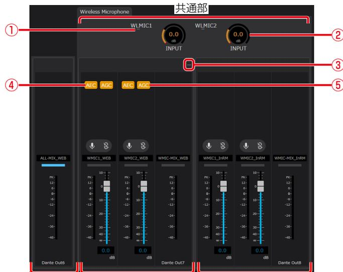
シーリングアレイマイクとワイヤレスマイクのミックスチャンネル部      リモート会議用ワイヤレスマイクチャンネル部      室内拡声用ワイヤレスマイクチャンネル部
