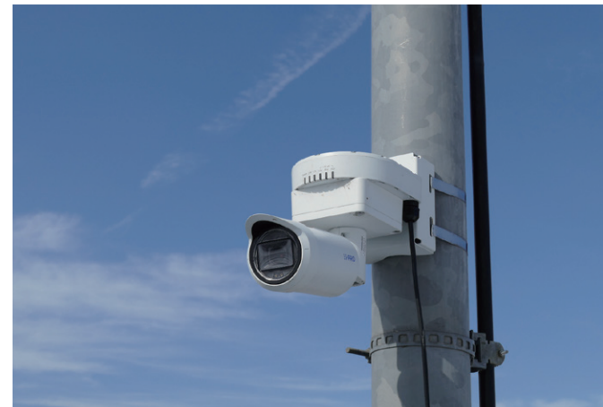
▲ 計装盤の状況を屋外ネットワークカメラとLTE無線通信ユニットで撮影・送信
