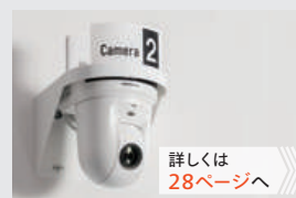
自動追尾システムで教員を捉える4Kのリモートカメラ AW-UE40W
