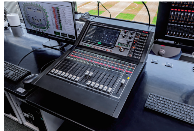
▲ アリーナ内の音響オペレーションを担うデジタルミキサーWR-DX350
