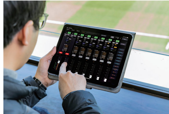
▲ WR-DX350本体と合わせ「iPad®用リモートコントロールソフト」も導入。iPad®からWR-DX350の状況をモニタリング可能
