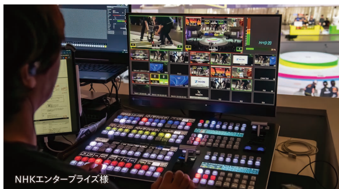
KAIROS操作卓とマルチビュー画面を使用し、リアルとバーチャルの映像を合成してライブ配信
