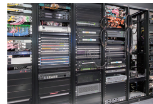
▲ 2サブのラック架。IP化でルーターも不要になり、VIDEO架が2本に収まる省スペースを実現
