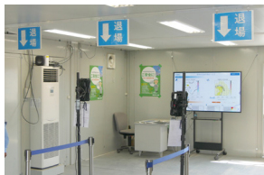
▲ 5台の顔認証端末(タブレット)を配備し、5レーンで工事エリアへの入退場を管理
