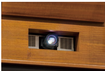
▲ 後方に設置されたPT-MZ16KJLW、16000 lmの高輝度映像を大型スクリーンに写し出す。
