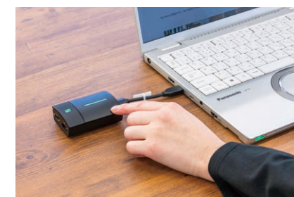
▲ ボタンを押すだけで簡単に画面共有。端のサブボタンを押すと最大4画面のマルチ画面に変更できる。
