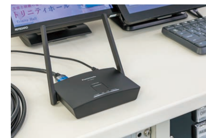
▲ 操作卓に設置されたPressIT受信機。
