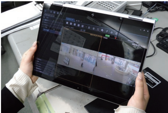
▲ 防災センターの専用端末(タブレット)でエントランスをモニタリング
