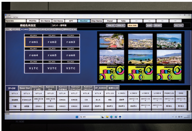
▲PSMのマルチビュー割付け画面。KAIROSのMV機能と連動して簡単に設定変更が可能
