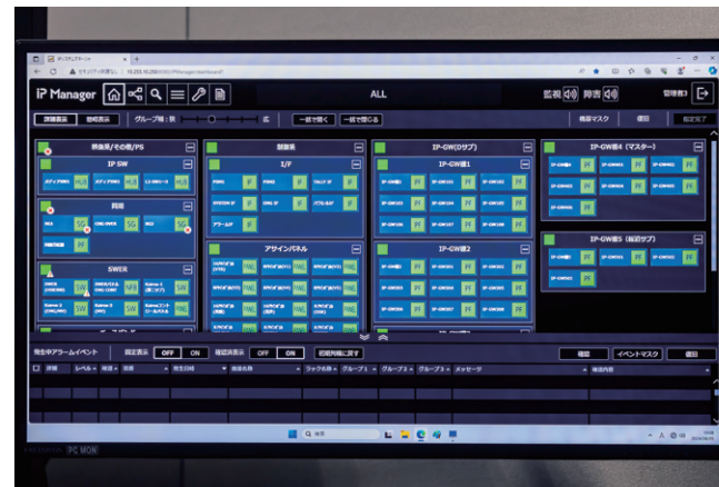
▲PSSのダッシュボード画面。機器の一括監視を行い、異常を検知するとアラートで知らせる
