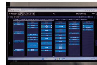
▲さらに、障害が発生した機器のラック内の位置を示すPSSのラック実装図表示画面
