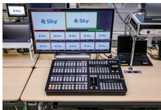
▲配信する映像のスイッチングを行うためのコントロールパネル
