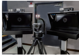
▲ 報道スタジオにはリモートカメラを3台導入。うち2台はプロンプターとして使用
