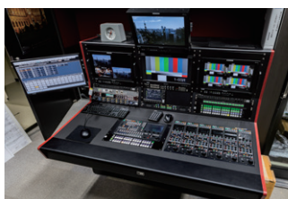
▲ 制作サブのVE卓にはMSUとROPを埋め込み。左手にはPSMの操作端末を設置
