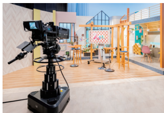
▲ スタジオカメラは4台活用。CCU無しでも使用できるため予備2台はENGライクな使用も想定
