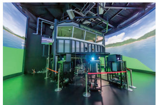
▲ 操舵室の階下に7台のPT-RQ25KJを半円状に設置して投写
