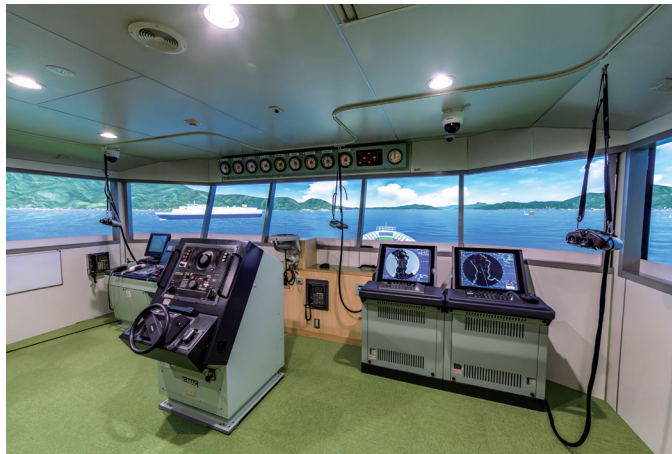
▲ 高度なブレンディング技術により、水平視角約249度の曲面に継ぎ目のない映像を投写
