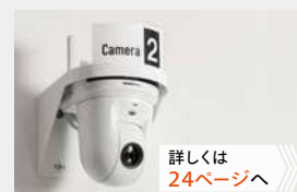
自動追尾システムで教員を捉える4KのリモートカメラAW-UE40W 詳しくは24ページへ »
