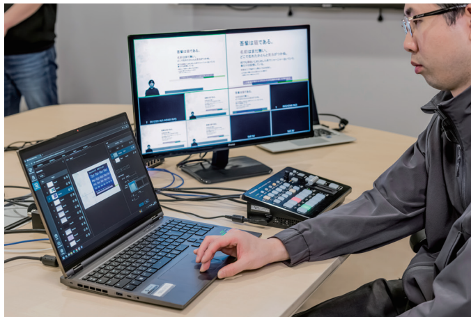
▲ ライブ配信時の撮影システム。Video MixerはノートPCにインストールされており、映像ソースとして、カメラ1台、資料映像送出用PC1台を入力
