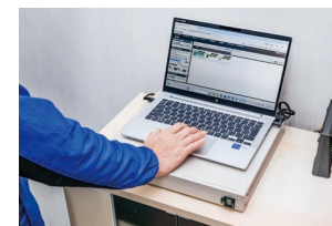
▲ コンテンツの差し替え、表示の切り替えは、AcroSign®の管理画面を用いて社内のPCから実施可能。ネットワーク機器などはPC下のラックに格納されている
