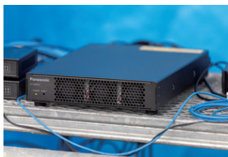
▲ 4K映像の入出力など、複雑なマルチプロジェクション演出をスムーズに実現するET-FMP50
