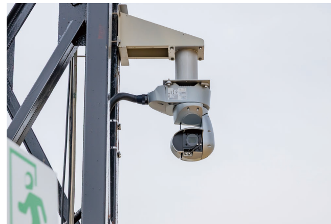
▲ AW-UR100GJは荒天時も安心のIP65に準拠。レンズ面にはワイパーを搭載しており、雨天でもクリアな視界で撮影できる
