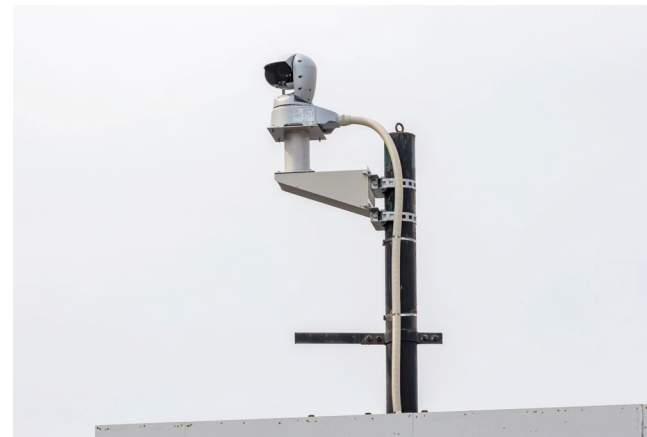
▲ ホームストレートのブリッジ看板上に設置されたAW-UR100GJ。光学式、電子式、パンチルト式の3種類の画揺れ補正機能を搭載し、不安定な場所でも安定した映像を撮影可能
