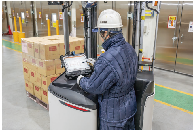
▲ フォークリフトに設置した端末タブブックCF-33で積荷状況の確認が行えます
