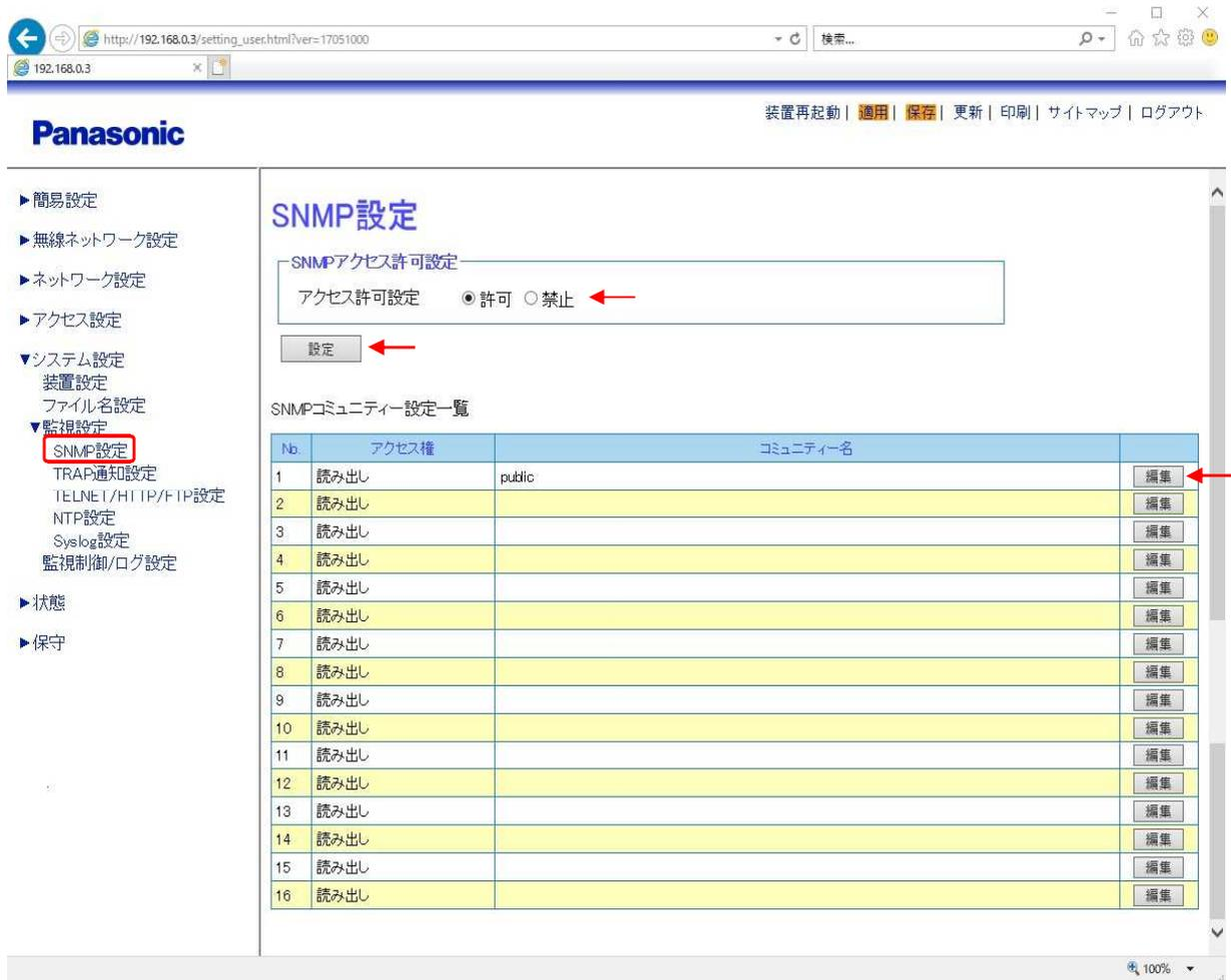
本装置はSNMPエージェントとしてSNMPマネージャーから監視、制御を行うことができます。本装置の遠隔監視制御を実現するためSNMPv1及びSNMPv2cをサポートします。本装置はMIB(ネットワークに接続された機器の状態を表す管理情報データベース)を管理し、SNMPマネージャからの要求に従ってMIB情報の読み出し/書き込みを行うことができます。
