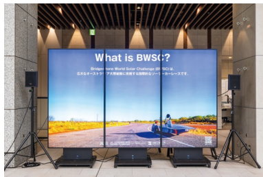
▶ TH-86SQ1HJを3台ずつ連結した表示パターン。音響機器(デジタルワイヤレスマイク、スピーカー)と組み合わせた運用も可能
