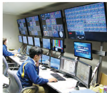
◀映像室に設置された確認用モニタには、広視野角の当社製55V型液晶ディスプレイを採用。
