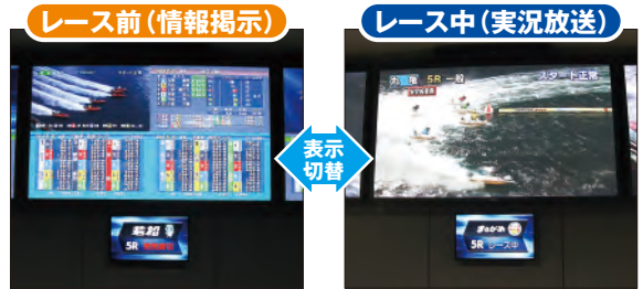
▲(左写真)レース前は「4入力マルチ画面表示」を駆使することで、ディスプレイ1台に多くの情報を表示してお客様に提供。1つの映像がおよそ50V型相当の大きさとなり、細かな文字情報も精細に表示できる。(右写真)レース中は実況映像を1画面で表示。「ディテールクラリティプロセッサ 3」により、動きの速いレース映像も緻密な表示が可能。映像室に設けられた制御用PCと各ディスプレイをLAN接続し、表示の切り替えなどの制御を一元管理している。
