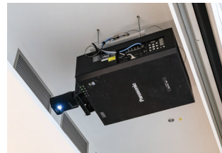
▲ 短い投写距離で映写可能な超短焦点レンズを装着したプロジェクターPT-RQ13KJ
