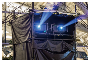
▲メイン画像を投写するPT-RQ25KJ。会場後方の左右に2台ずつ設置
