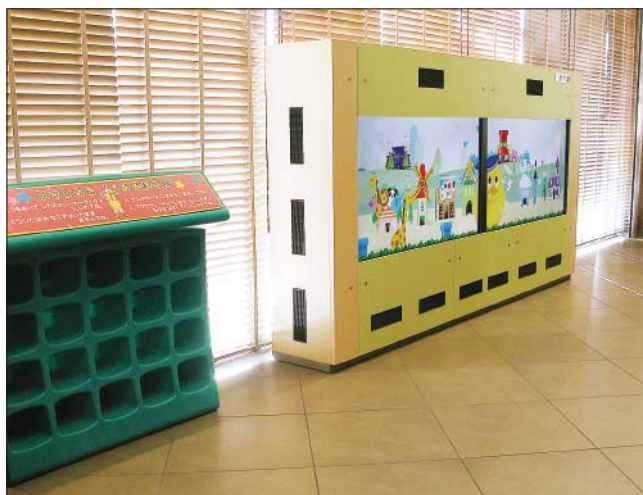
▲65V型ディスプレイ×2台と、コンテンツを再生するPC、スピーカーとアンプなどをひとつの筐体にまとめた「デジタルプレイランド」。冷却用ファンも装備している。
