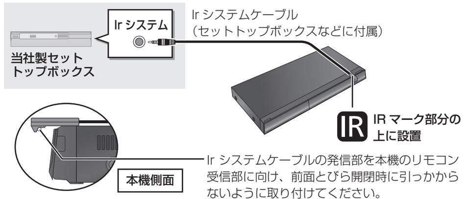
Ir システムケーブルの発信部を本機のリモコン受信部に向け、前面とびら開閉時に引っかからないように取り付けてください。
