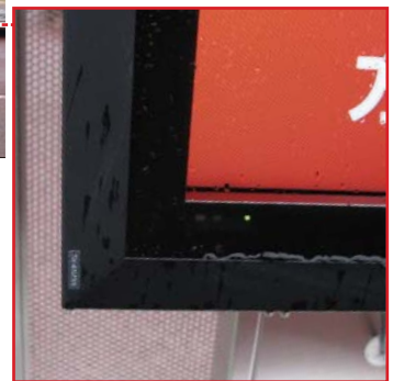
雨天時の様子 ▲▶ 画面に水滴がかかっても問題なく動作し、映像を表示する。
