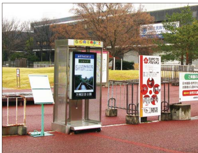
▲ディスプレイの角に人がぶつくと危険なので、全体を覆うような形状の筐体を製作した。
