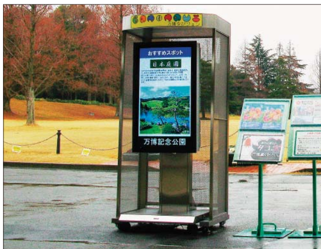
▲堅牢液晶ディスプレイの採用により屋外設置を実現した「万博ナビジョン」。DIGITAL LINKを活用することで、ディスプレイを屋外、映像ソースは屋内に設置。
