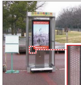
雨天時の様子 ▲▶ 画面に水滴がかかっても問題なく動作し、映像を表示する。
