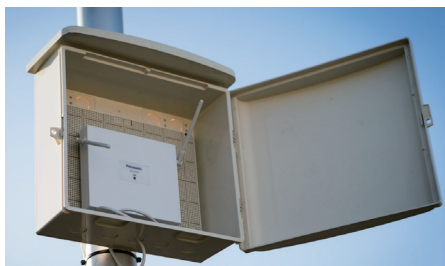
駐車場屋上に設置されたアンテナステーション WX-CR200
