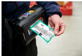
▲全ての入力を終え「OK」ボタンを押すと、腰に装着したプリンタから入庫タグが出力されます。
