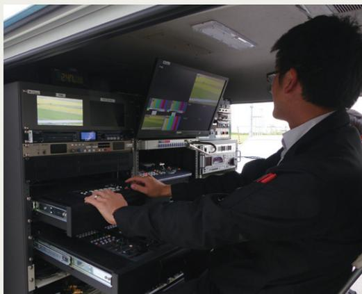
中継車内に搭載したリモートカメラコントローラー AW-RP50でカメラ制御が可能
