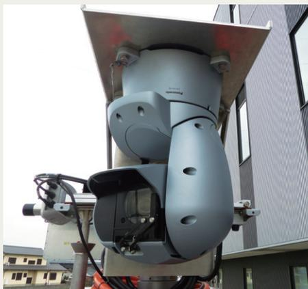
中継車上部に設置された屋外対応HDインテグレートドカメラ AW-HR140
