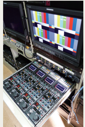
液晶パネルで高い操作性を実現する リモートオペレーションパネル (ROP) AK-HRP1000
