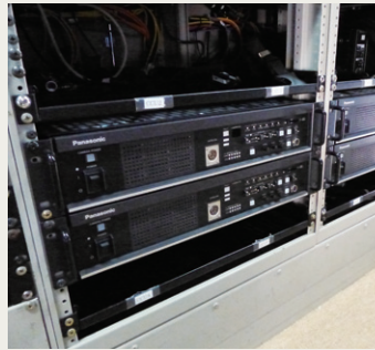
中継車内に積載された カメラコントロールユニット (CCU) AK-UCU500
