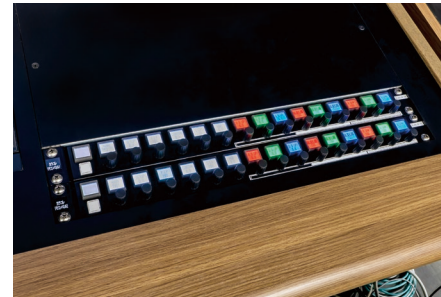
▲VE卓に埋め込まれたKAIROSのカラコレ操作ボタン。分かりやすく色分けされ、ワンボタンで映像素材の色調整が可能
