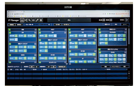
▲機器の一括監視を行い、異常を検知するとアラートで知らせるPSS (Panasonic System Surveillance)のダッシュボード画面
