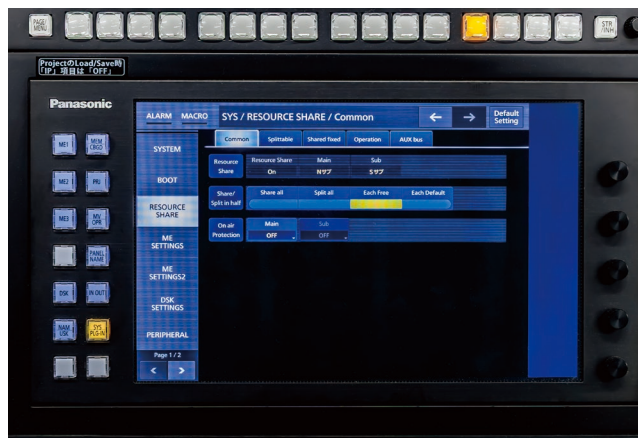
▲ AV-HS8300のメニューパネル。SサブとNサブのリソースシェアの設定をタッチパネルで切り替えることが可能
