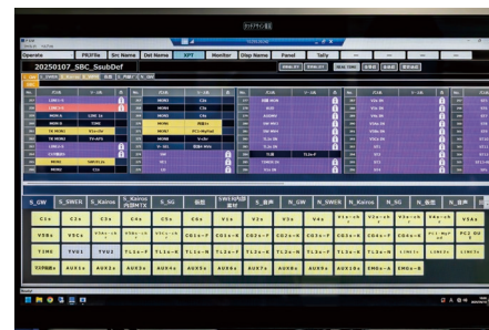
▲PSM (Panasonic System Manager)のクロスポイント切り替え画面
