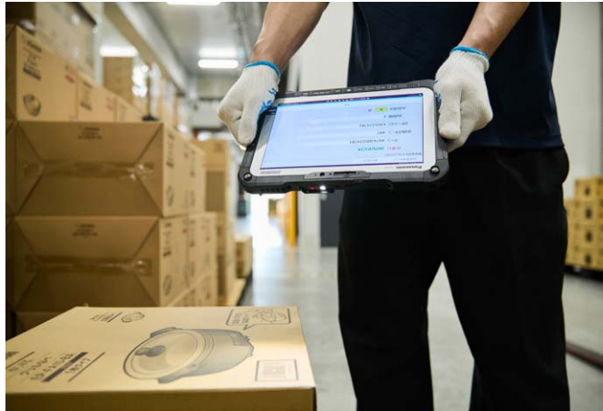
▲バーコードリーダーが搭載されていることで、外付けの小型スキャナがなくてもボタンワンタッチでスキャンできるように。
