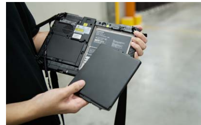
▲バッテリーを交換することで、端末をより長く使い続けられるという。ワンタッチで外せて現場で交換できるため、管理工数も削減できる。
