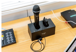
▲1.9 GHz帯ワイヤレスマイクシステム(ハンドヘルド型マイク・タイピン型マイク・充電器)
